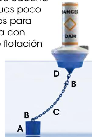
Boya de espeque con flotadores de barrera señalización de represas, zonas de nado) con cadena
