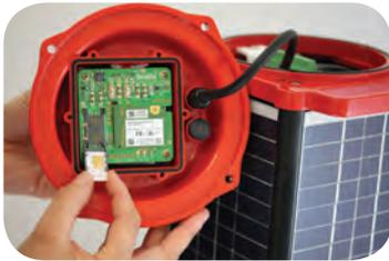
Módulo GSM y tarjeta SIM
